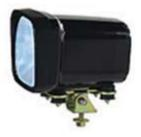
Es la lámpara más duradera del mercado. Su carcasa de aluminio y estructura le hacen muy resistente a los golpes y las vibraciones. Lente de vidrio templado. Puede montarse en posición vertical, colgante, lateral izquierda o lateral derecha. Cuenta con un soporte que aguanta los trabajos más pesados. Conector Deutsh de dos clavijas integrado.
